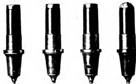
Fig. 5 - Perforazioni di isolanti di mica.
